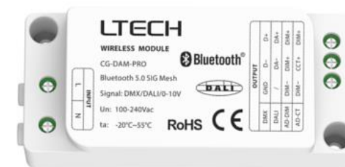
3 in 1 (DALI/DMX/0-10V)module CG-DAM-PRO
